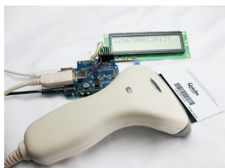
Εικόνα 3.9. Συσκευή γραμμωκώδικα με χρήση πλακέτας Arduino.
